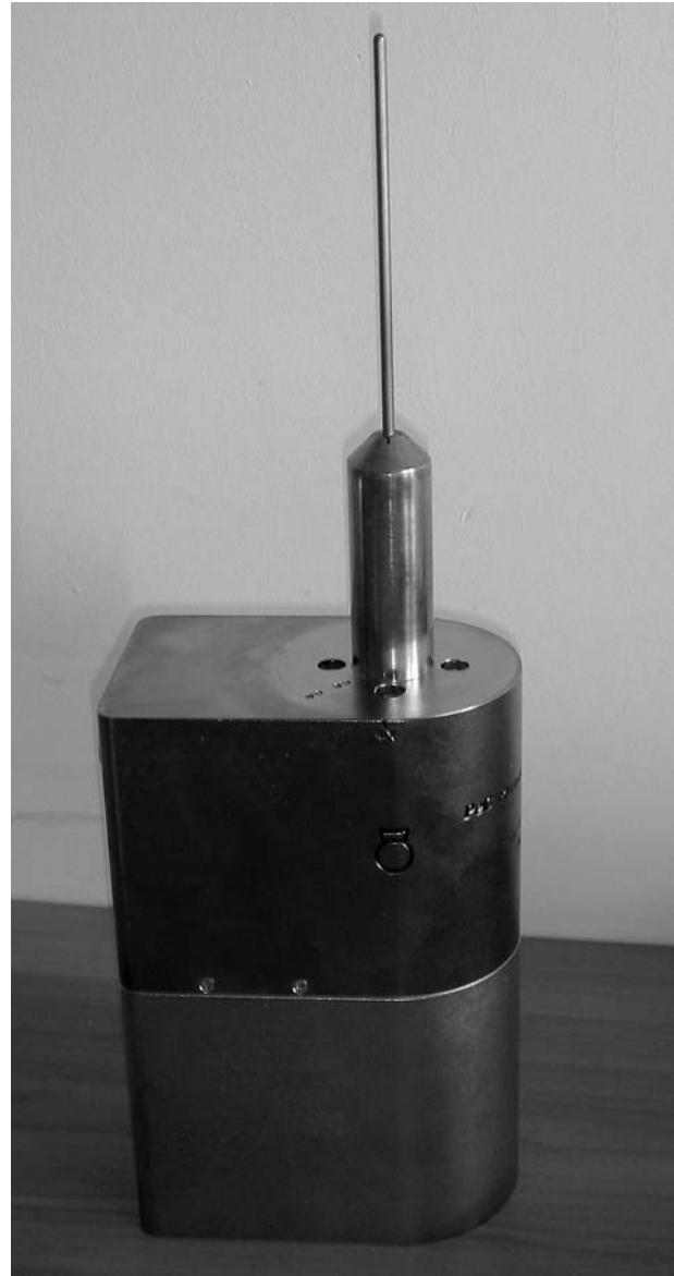
Ryc. 2. Źródło promieniowania systemu PRS 400 (katoda, przyspieszacz, anoda)
