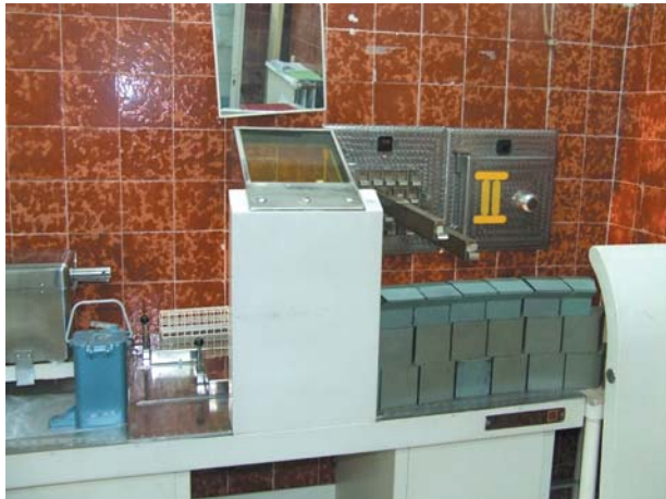
Ryc. 1. Stanowisko pracy przygotowane do zatopienia w szkle źródeł radu-226
