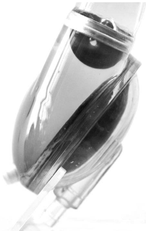
Ryc. 3. Skrzeplina w komorze wspomagania widoczna w okolicy membrany.
