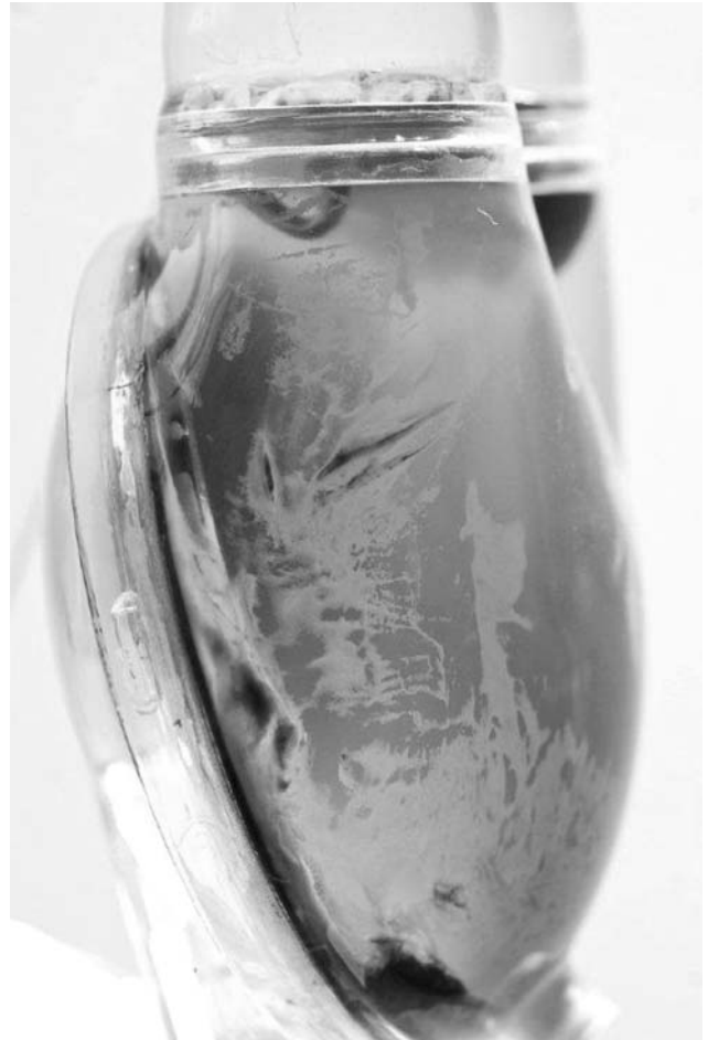
Ryc. 4. Złogi włóknika widoczne na czaszy części krwistej komory wspomagania.
