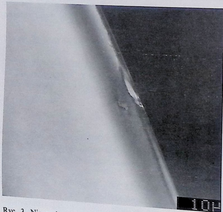
Ryc. 3. Nieregularności krawędzi części optycznej
