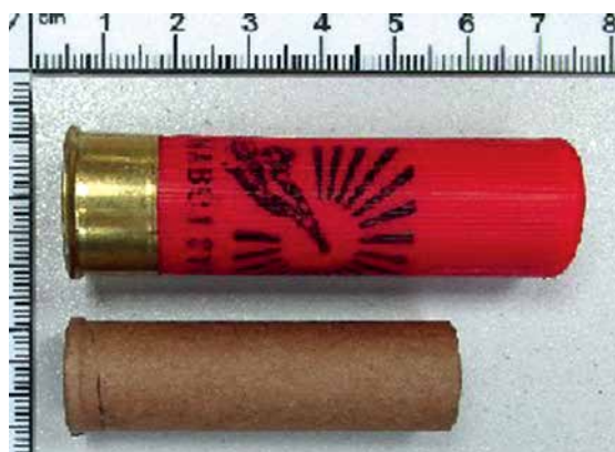
Ryc. 6. Amunicja sygnałowa kal. 12 produkowana w Polsce, u góry nabój, na dole wkład sygnałowy [ze zbiorów Laboratorium Kryminalistycznego Komendy Wojewódzkiej Policji we Wrocławiu]
