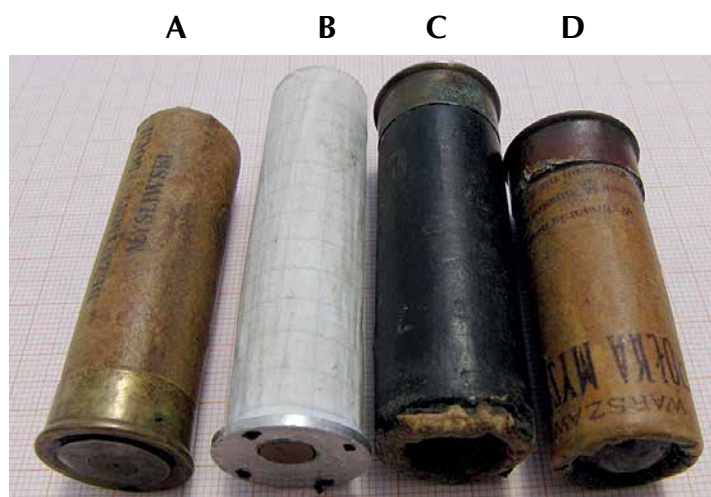
Ryc. 9. Samodziółowe naboje kłusownicze; od lewej: A) kal. 16 – zamiast spłonki użyto odciętego denka naboju mosina, B) kal. 16 – kryza wykonana z monety, zamiast spłonki wykorzystano nabój sportowy starterowy 6 mm osadzony mimośrodowo na stalowej podkładce wklejonej w denko naboju; C) kal. 12 – nabój śrutowy z przerobionego moździerzowego ładunku miotającego, D) kal. 12 – nabój do polowania na dziki, pocisk wykonany z ołowianej kuli szrapnela z I wojny światowej [ze zbiorów Muzeum Medycyny Sądowej Uniwersytetu Medycznego we Wrocławiu]
