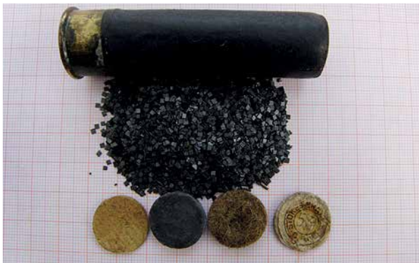
Ryc. 11. Anatomia moździerzowego ładunku miotającego Stokes-Brand 81 mm produkcji Cartoucherie Francaise; od góry: kartonowa czarna łuska (o wymiarach naboju myśliwskiego kal. 12 × 70 mm), ładunek prochowy (11 cm 3 ); na dole od lewej: kartonowa przybitka, ołowiany popychacz, filcowy amortyzator, zatyczka [ze zbiorów Muzeum Medycyny Sądowej Uniwersytetu Medycznego we Wrocławiu] Fig. 11. The anatomy of Stokes-Brand 81 mm mortar bomb, by Cartoucherie Francaise, from top: carton black shell (the same dimensions as a hunting cartridge, cal. 12 × 70 mm), gunpowder charge (11 cm 3 ); at the bottom from left: carton wad, lead ring, felt damper, crimp (label) [from collection of the Forensic Medicine Museum, Wrocław Medical University]
