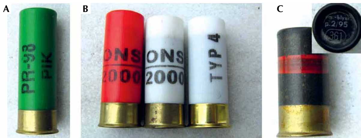
Ryc. 5. A) Nabój z pociskiem proszkowym PR-98 PIK [ze zbiorów Laboratorium Kryminalistycznego Komendy Wojewódzkiej Policji we Wrocławiu]; B) i C) naboje dźwiękowe (hukowe) kal. 12: ONS2000 stary wzór, ONS2000 nowy wzór, typ 4 (obecnie stosowany) (B), „dym-błysk”, wkład do granatów ćwiczebnych CRG42 lub CRG42A, ze względu na spektakularne efekty odstrzeliwane czasami przy rozpędzaniu nielegalnych zgromadzeń (C) [ze zbiorów Muzeum Medycyny Sądowej Uniwersytetu Medycznego we Wrocławiu]
