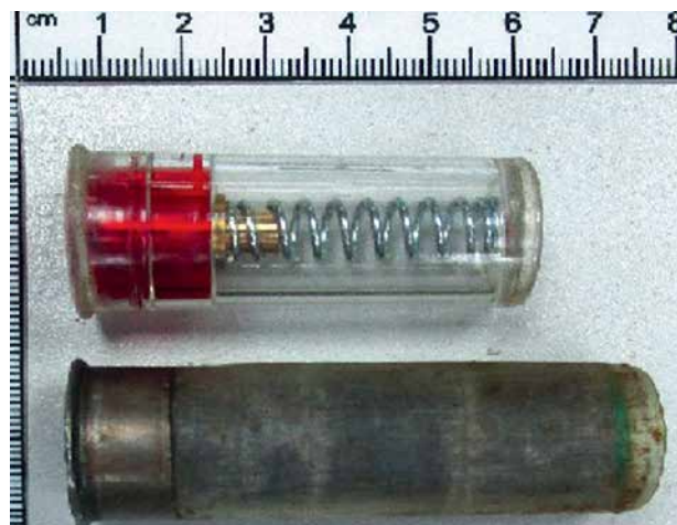
Ryc. 8. Amunicja szkolna – treningowa („zbijaki”), na górze – ze sprężyną, na dole bez sprężyny [ze zbiorów Laboratorium Kryminalistycznego Komendy Wojewódzkiej Policji we Wrocławiu]
