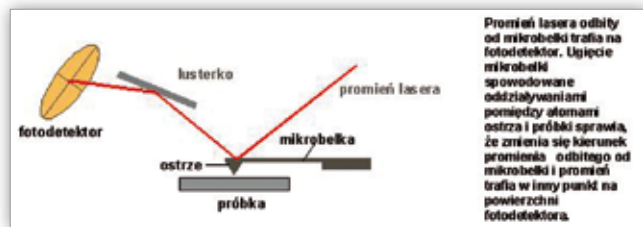
Ryc. 1. Pomiar ugięcia mikrobелki za pomocą metody detekcji odchylenia wiązki laserowej [por. np. (2), (5)].
