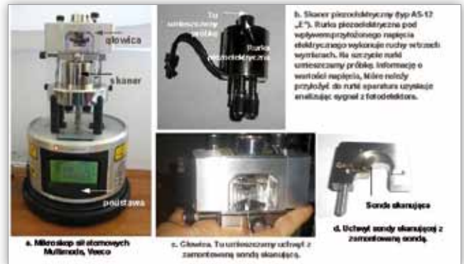
Ryc. 2. Elementy mikroskopu sił atomowych Multimode, Veeco – a.; skaner piezoelektryczny (typ AS-12 „E”), rurka piezoelektryczna pod wpływem przyłożonego napięcia elektrycznego wykonuje ruchy w trzech wymiarach. Na szczycie rurki umieszczamy próbkę. Informację o wartości napięcia, które należy przyłożyć do rurki, aparatura uzyskuje, analizując sygnał z fotodetektora – b.; głowica, tu umieszczamy uchwyt z zamontowaną sondą skanującą – c.; uchwyt sondy skanującej z zamontowaną sondą – d. (autorka zdjęć: Justyna Bronowicka).
