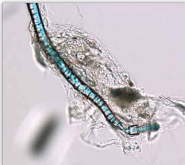
Ryc. 4. Degradacja szwu; obraz z mikroskopu świetlnego (powiększenie 40 razy). Fig. 4. Degradation of polypropylene suture. The picture of optic microscopy (magnification 40 x).
