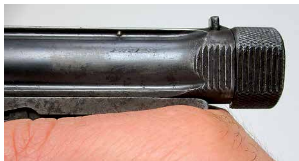
Ryc. 14. Mechanizm powstawania obrażeń na ręce strzelającego z pistoletu S&S wz. 1919 kal. 6,35 mm podczas powrotu zamka ku przodowi po danym strzale
