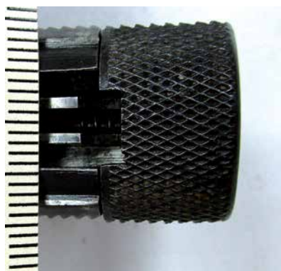
Ryc. 13. Nakrętka zamka – widok dłutowato uformowanego wycięcia w dolnej jej części pistoletu S&S wz. 1919 kal. 6,35 mm
