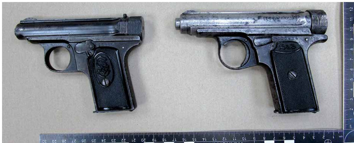
Ryc. 12. Pistolety samopowtarzalne Sauer & Sohn (od lewej): wz. 1919 kal. 6,35 mm oraz wz. 1913 kal. 7,65 mm Fig. 12. Sauer & Sohn semi-automatic pistols (from left): Model 1919 6.35 mm and Model 1913 7.65 mm
