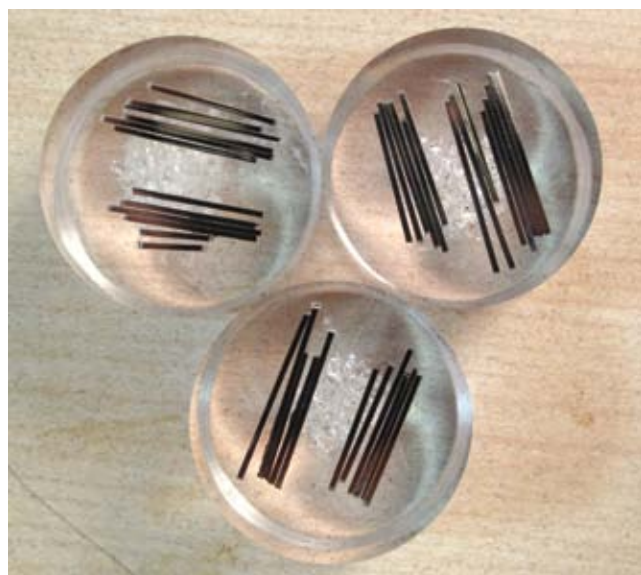
Ryc. 4. Zamocowane próbki do badania mikrotwardości.
